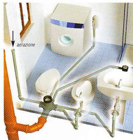
Fig. 3 - Collegamento parallelo: orientamento dello scarico del collettore sul retro del WC
