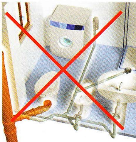
Fig. 1 - Collegamento in serie: l'ostruzione di una braga blocca tutto l'impianto a monte
