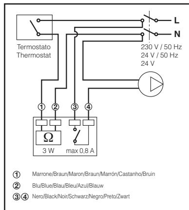
Il microinterruttore ausiliario si chiude per un valore medio di apertura del comando elettrotermico dell'80%.
